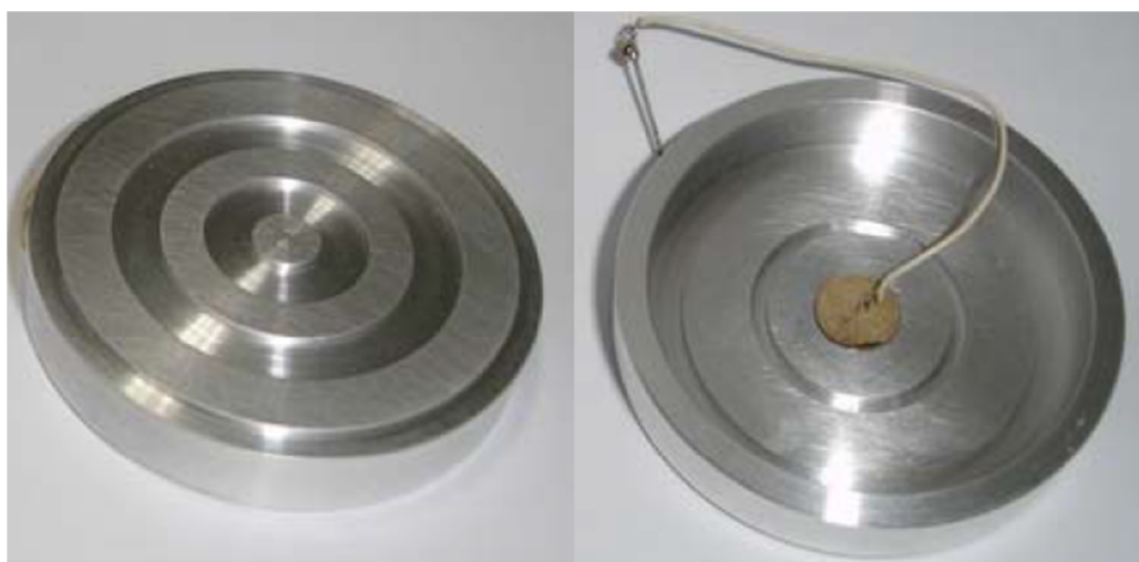
Figura 3: Transdutor com ranhuras em ambas as faces (Buiochi, 2008).
